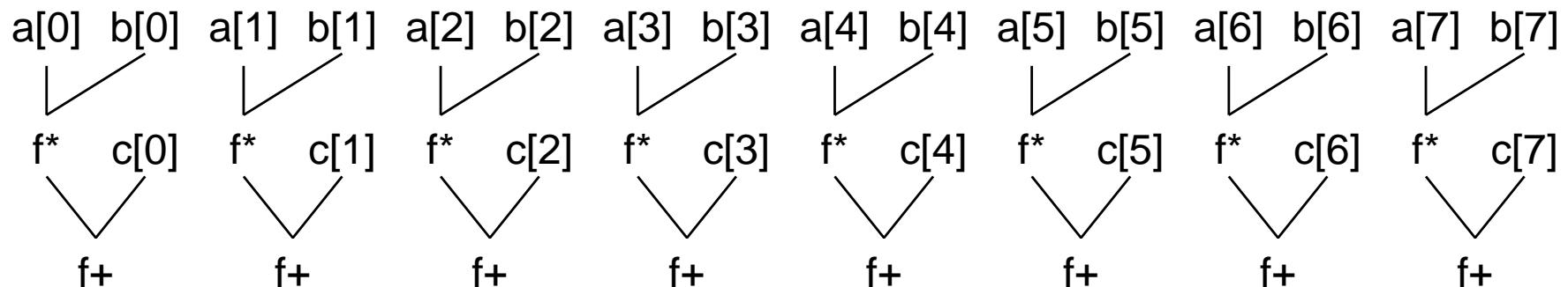
a 8 floats v@ b 8 floats v@ vf\* c 8 floats v@ vf+
