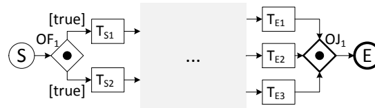
Abbildung 5. Verknüpfung mehrerer Start- und Endknoten zu einem einzigen
