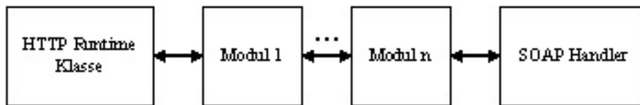
Abbildung 7: Pipeliningprinzip des ASP.NET Frameworks bei einem IIS
